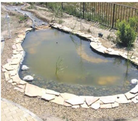
иметь припуск на укладку в траншею и возможность засыпать ее за пределами траншеи. Параллельно с укладкой пленки водоем заполняют водой, что дает дополнительное выравнивание материала. Пленку временно следует закрепить по краю камнями или мешочками с песком, чтобы предохранить ее от сползания в котлован при заливке водой. Окончательно пленку закрепляют после заполнения его водой. Только после этого лишнюю пленку по периметру можно обрезать, а край задекорировать.
