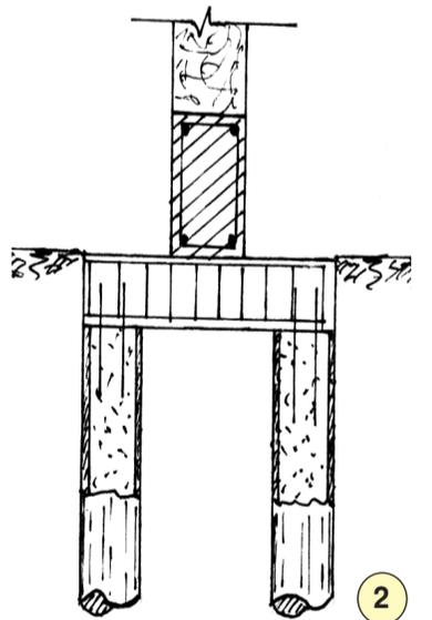
фундаменты, уложите на каждую их пару железобетонные балки (2). Забетонируйте утопленные винтовые столбы до уровня верхних балок, далее уложите (забетонируйте) по балкам и стойкам железобетонные рандбалки высотой 15 см. Сделайте цоколь (бетонный без армирования или кирпичный), уложите на него гидроизоляцию из двух слоев рубероида со швами, промазанными расплавленным битумом, или из гидроизола с проваркой стыков паяльной лампой, и опустите дом на цоколь.
