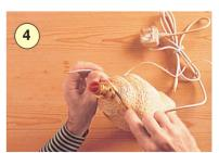
4. Доведя обмотку до патрона лампы, обмоточный шнур снова закрепляют и обрезают.
