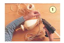
2. Сделав несколько витков обмотки вокруг, шнур закрепляется на корпусе лампы.
